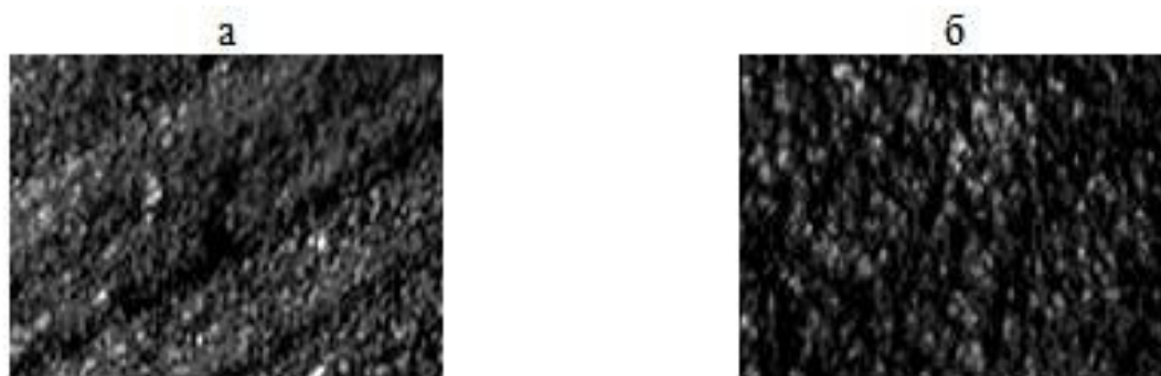
Рис. 4. Поверхность кобальтовых покрытий, полученных в режиме реверсивного тока ( \tau_k \div \tau_a = 20 \div 4 ) после отжига при 300 °С ( \times 1200 ): а – рН 1,0; б – рН 3,0
