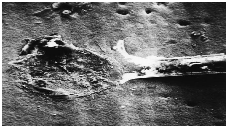
Рис. 1. Внешний вид полного коррозионного разрушения микросварного контакта алюминиевой проволоки с золотым гальванопокрытием в дистиллированной воде
