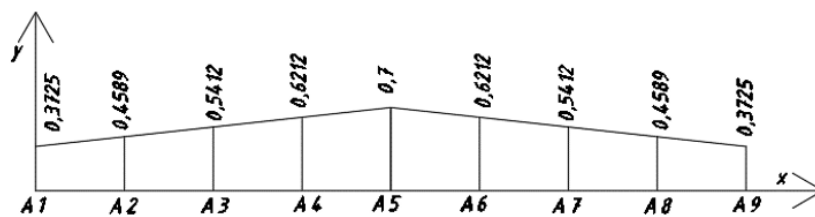
Рис. 3. Схема распределения симметричной снеговой нагрузки ( \frac{\text{кН}}{\text{м}^2} ) с шагом 3м по поверхности свода
