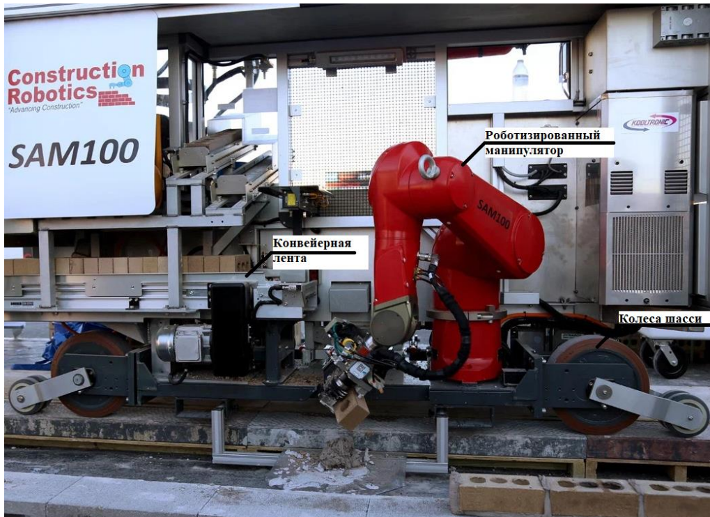
Рис. 4. Полуавтоматический робот SAM 100 (2015 год)
