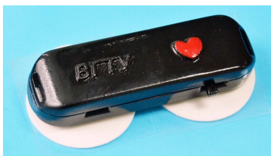
Рис. 52 – Внешний вид разработанного макета с установленными электродами.
