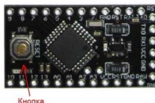
Рис. 32 – Использование кнопки "RESET" при загрузке программы
