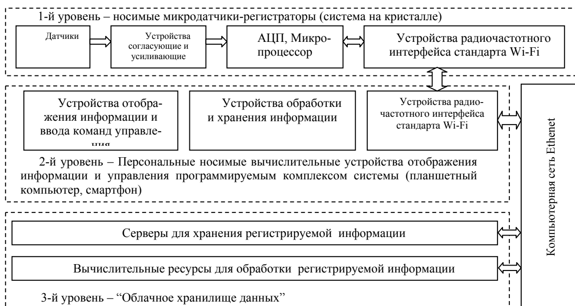
Рис. 7. – Трехуровневая дистанционная ИВС
