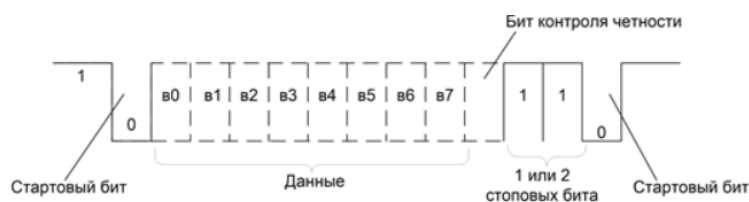
Рис. 11. - Пояснение контроля четности
