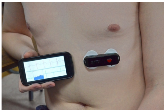
Рис. 53 – Микродатчик-регистратор в процессе съема электрокардиосигнала.
