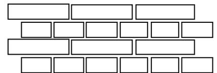
16. Для стен и перегородок толщиной в  $\frac{1}{2}$  кирпича используется техника перевязки
