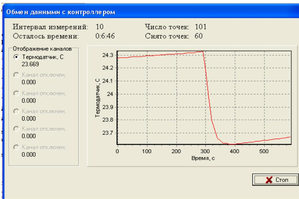
11. Когда изменение температуры станет незначительным и равномерным, нажмите кнопку «Стоп». При этом экспериментальные данные автоматически запоминаются и установка переходит в режим управления. Измерение может закончиться автоматически, когда будет проведено заданное число измерений (100). Если обработка экспериментальных данных будет выполняться после проведения всех экспериментов, то для проведения следующих измерений нажмите кнопку «Текущее состояние».
