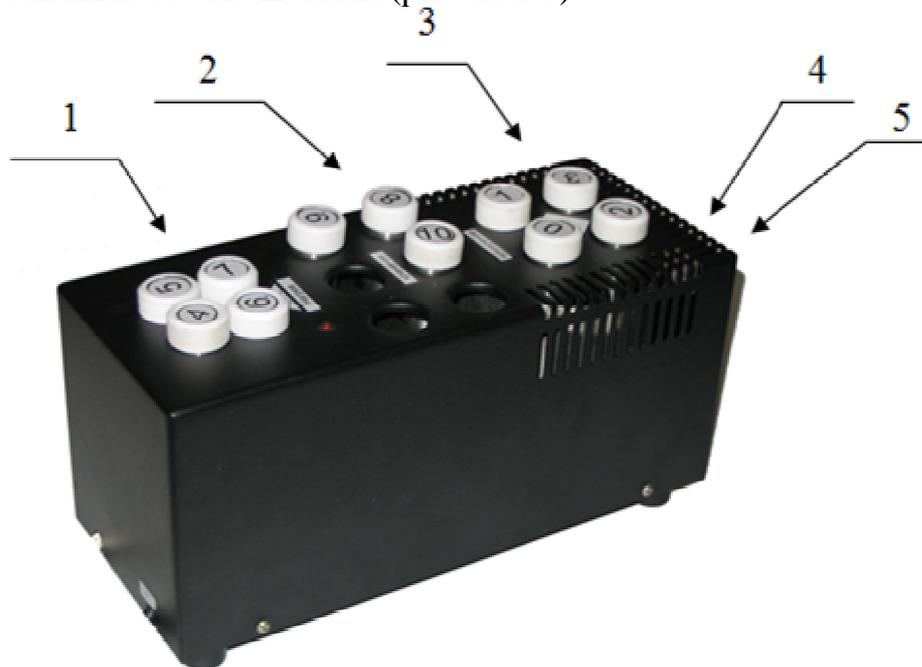
**Рис. П.1.9.** Модуль «Термический анализ» с ампулами: 1 – гнезда для ампул измерительного блока, 2 – гнезда для хранения ампул, не задействованных в опыте, 3 – гнезда для ампул нагревательного блока, 4 – кабель связи с контроллером, 5 – сетевой кабель (на задней панели модуля)
