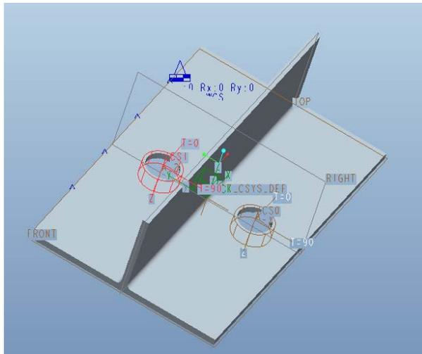
Рис. 12. Задание системы координат во втором отверстии
