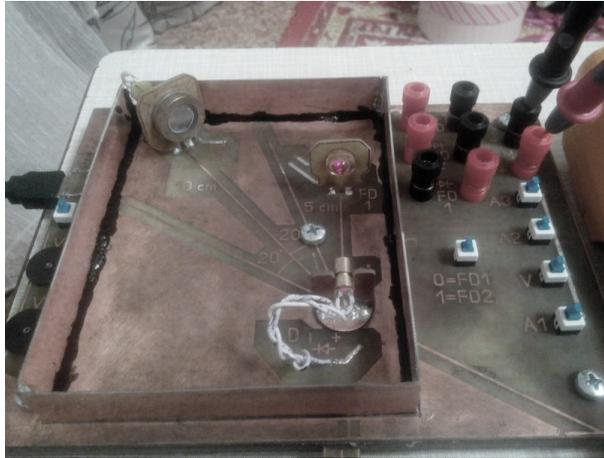
Рис. 4.7. Установка для измерения характеристик и параметров лазерных диодов
