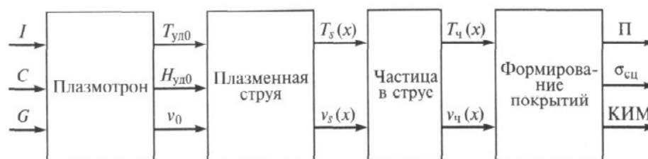
Рис. 1. Стадии процесса плазменного напыления
