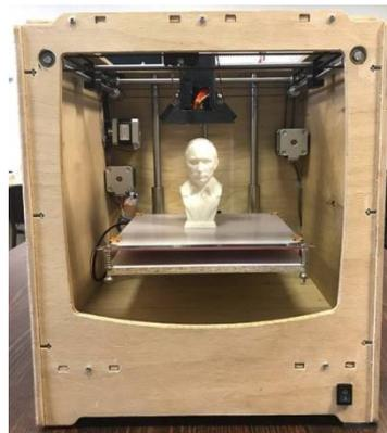
Рис. 4. Рабочий образец FDM принтера.
