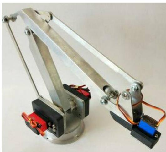
Рис. 2. прототип учебного робота РС-121
