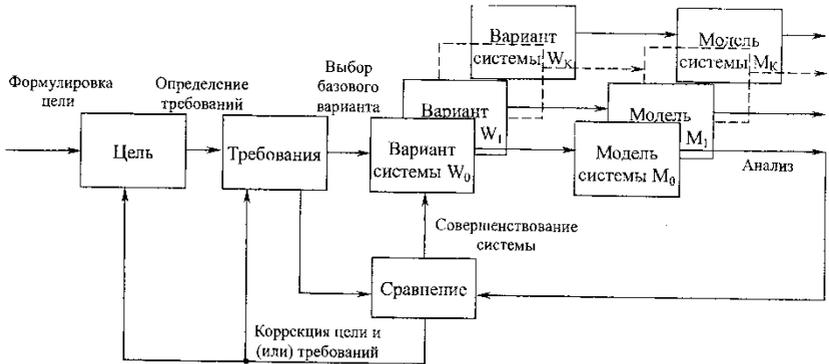
Рисунок 1 – Структура процесса проектирования технического объекта
