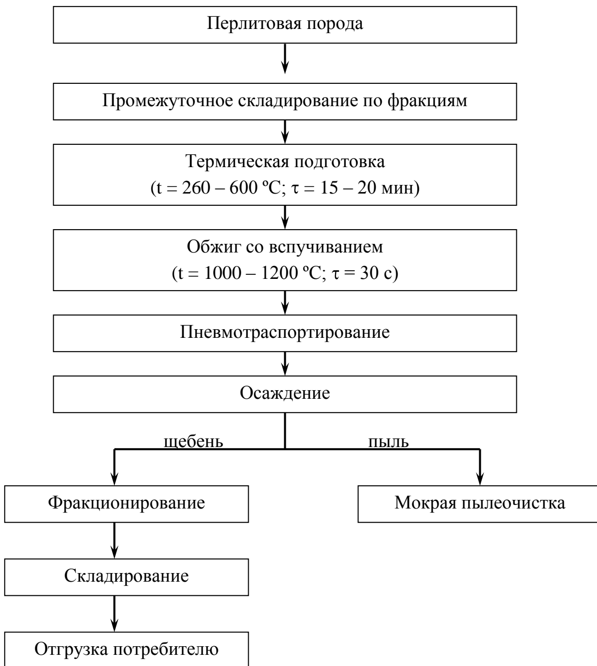
Рисунок 4 - Функциональная схема производства вспученного перлитового щебня
