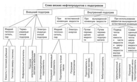
Рис.7. Классификация способов подогрева вязких нефтепродуктов
