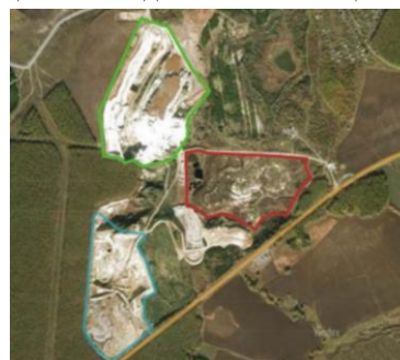
Рис. Съемка со спутника. Расположение полигонов, карьеров. Цвета (красный- полигон «ПОО» в карьере «Средний»; синий- полигон ТБО «Каскад»; зеленый- территория действующего карьера)
