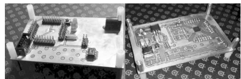
Рис. 6. Изготовленный макет обнаружителя
