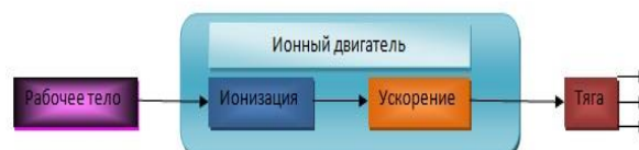
Рис. 2. Принцип работы ИД
