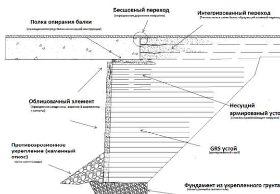
Рис. 1. Иллюстрация сечения устоя
