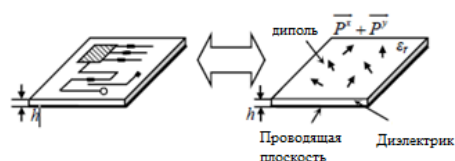
Рис. 1. Модель конфигурации диполь – диэлектрик – проводящая плоскость
