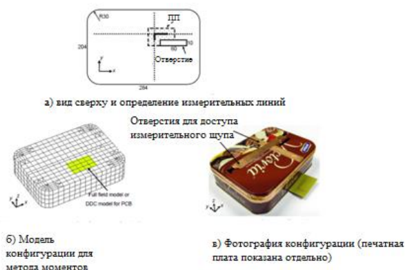
Рис. 4. Конфигурация Г-образный микрополосковой платы внутри корпуса для резонансного моделирования
