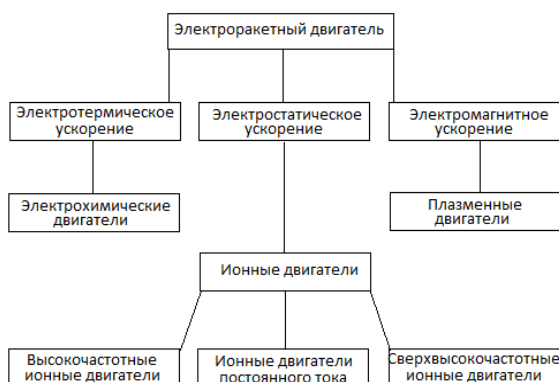
Рис. 1. Схема типов ЭРД.
