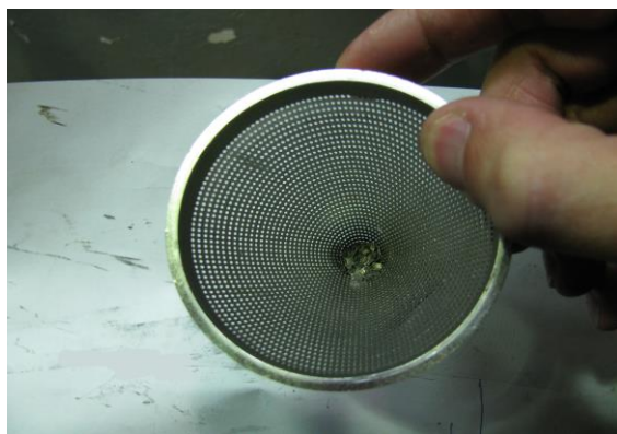
Рис. 2. Фильтр после газового канала
