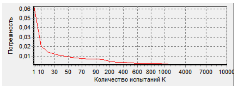
Рис. 4. Зависимость погрешности вычисления дисперсии от количества испытаний K
