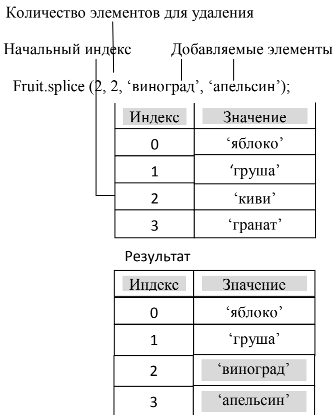
Рис. 3. Результат замены элементов массива с помощью команды splice()
