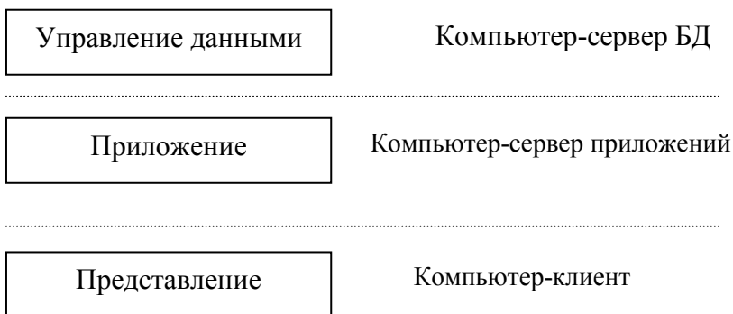
Рис. 7.3. Трехзвенная модель сервера приложений
