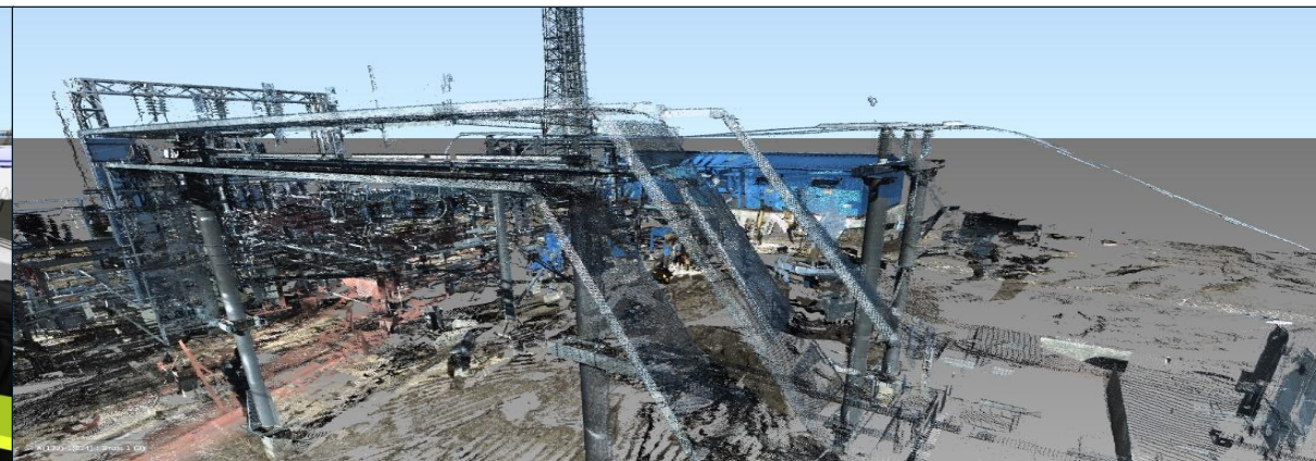
Лазерное сканирования участка стройки – облако точек
