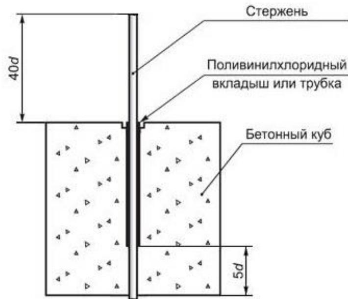
Схема испытания методом осевого выдергивания из куба.
