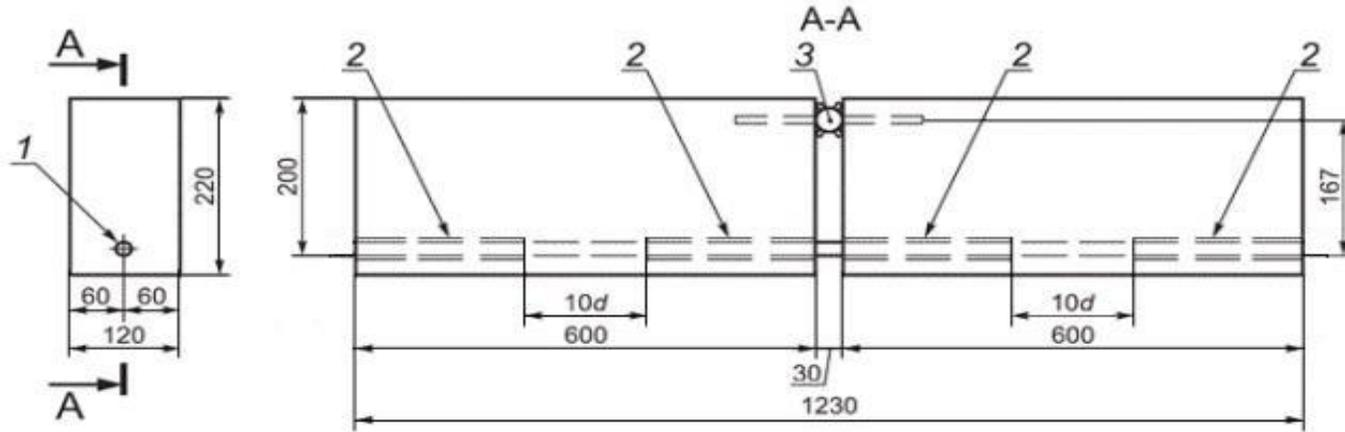
схема испытаний образца
