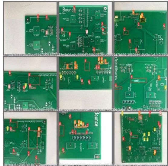
Рис. 3. Форма разметки изображений для создания обучающей и валидационной выборки
