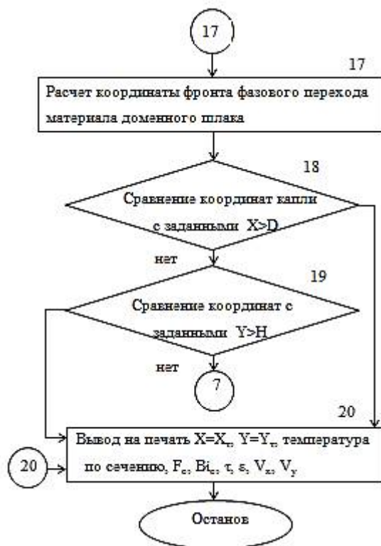
Рис. 6. Алгоритм прогнозирования теплообмена при охлаждении капли доменного шлака в потоке газа (продолжение)
