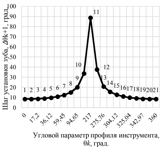
Рис. 8. Изменение шага зуба k+1 , приходящегося на угловой параметр \theta_k профиля инструмента для обеспечения точности в T\Delta_k = 200 \text{ мкм}
