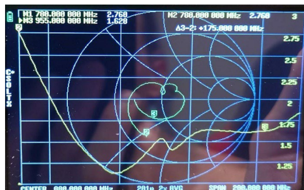
Рис. 9. Измерение S параметров экспериментальной антенны
