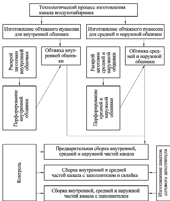
Рис. 2. Схема технологического процесса изготовления канала воздухозаборника
