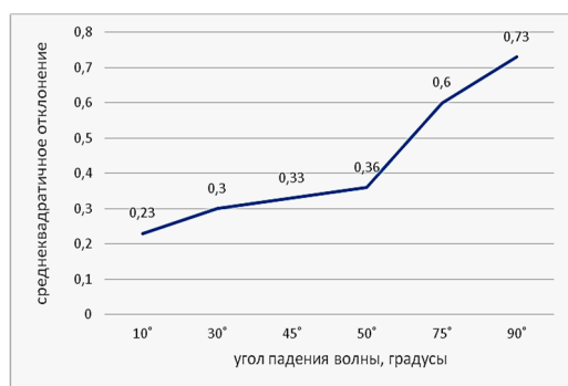
Рис. 7. Среднеквадратичное отклонение аппроксимированных значений нормированной амплитуды поля от его истинного значения при различном угле места падающей волны (угол места 90^\circ соответствует скользящему падению волны вдоль решетки)
