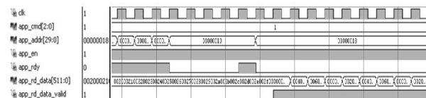
Рис. 10. Временная диаграмма процесса чтения из памяти DDR3
