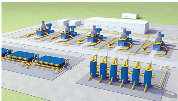
Рис. 2. Классическая схема обвязки основного технологического оборудования
