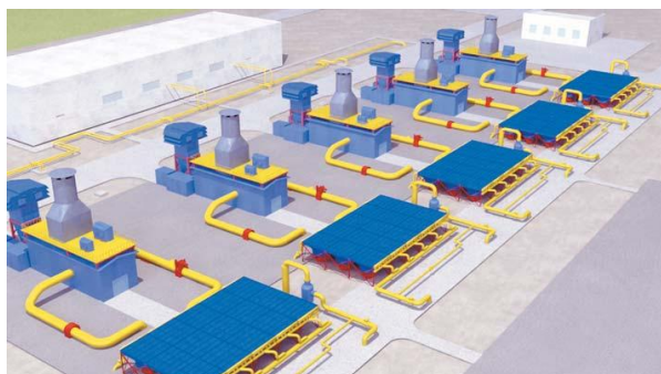
Рис. 3. Блочно-модульная схема обвязки основного технологического оборудования КС
