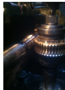
Рис. 14. Нарезание червячного колеса на зубофрезерном станке 5К32А фрезой с разделенным по высоте профилем инструментальной рейки
