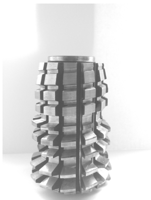
Рис. 13. Червячная фреза с разделенным припуском для обработки m=3 , d_{a0}=58,5\text{мм}
