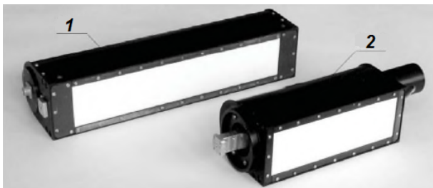
Рис. 9. АДИ с механическим способом сканирования ДН, содержащая: 1 – 40 ДР; 2 – 8 ДР
