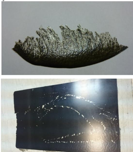
Рис. 1. Агломерация углеродных нанотрубок в отвержденных образцах Т99-1
