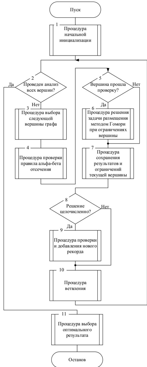
Рис. 1. Структурная схема модифицированного алгоритма метода ветвей и границ с применением метода Гомори
