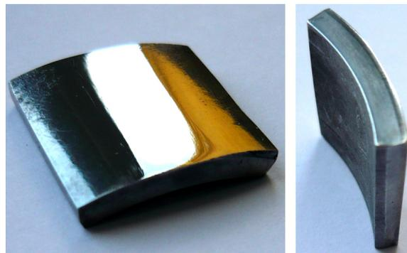
Рис. 1. Фрагменты шлиф-образцов для исследований, вырезанные из цилиндрических макетов деталей
