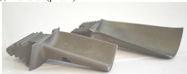
Рис. 2. Рабочие лопатки турбины
