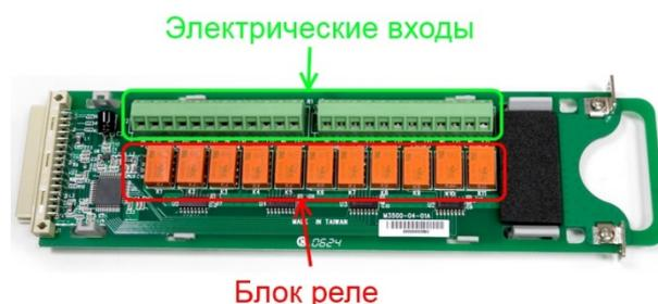
Рис. 3. Десятиканальный сканер для вольтметра В7-78/1
