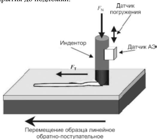
Рис. 1. Схема испытания на адгезионную прочность
