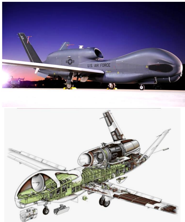
Рис. 1. Общий внешний вид и внешний вид в разрезе БЛА RQ-4 (Global Hawk)
