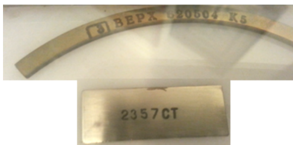
Рис. 4. Вид поверхностей деталей с нанесенными информационными знаками (покрытие снято)
