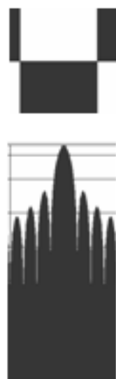
Рис. 1. Спектральная характеристика сигнала с прямоугольной огибающей элементарной посылки
