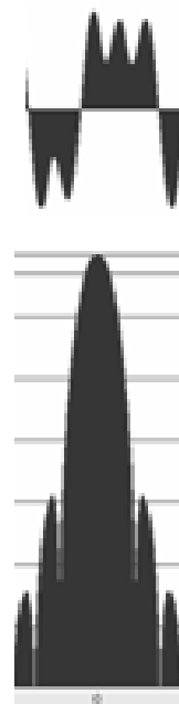
Рис. 2. Спектральная характеристика сигнала с синусоидальной огибающей элементарной посылки
