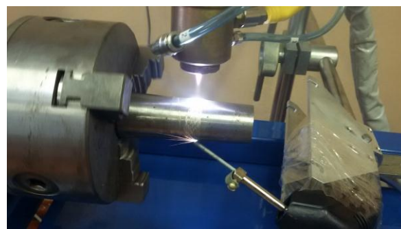
Рис. 5. Разработанная экспериментальная установка для нанесения покрытий
