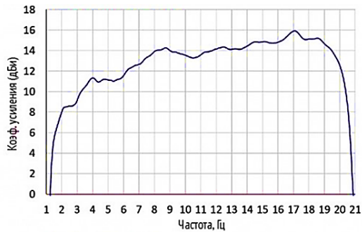
Рис. 3. Распределение коэффициента усиления RFspinDRH20
