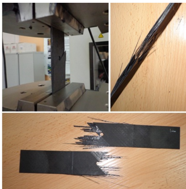
Рис. 4. Внешний вид образца ПКМ с диапазоном нагружения 10-70 %
