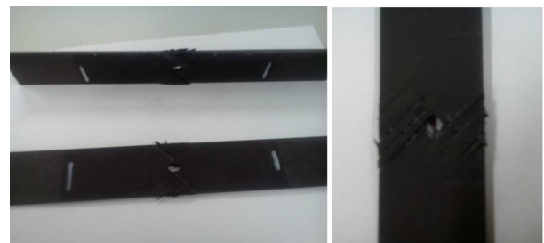
Рис. 3. Внешний вид образца ПКМ после испытаний на растяжение с отверстием
