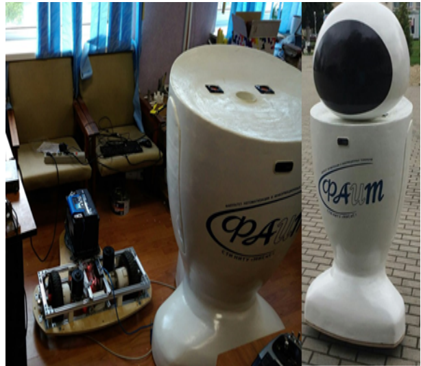
Рис. 2. Общий вид робота-телеприсутствия для реализации функций автономности
