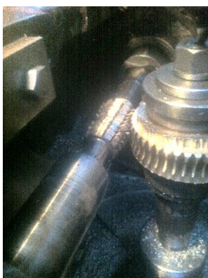
Рис. 4. Нарезание червячного колеса фрезой новой конструкции
