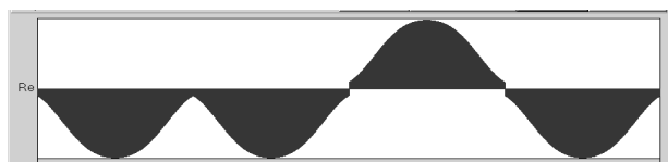
Рис. 5. Вид сигнала ФМн-2 с колоколообразной огибающей элементарной посылки, заданной с помощью полиномов Лежандра
