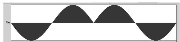
Рис. 4. Вид бинарного фазоманипулированного импульса синусоидальной огибающей элементарной посылки
