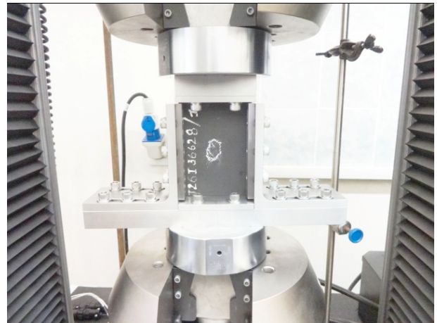
Рис. 4. Локальные повреждения на поверхности элементарного образца
