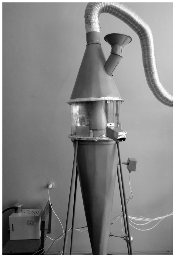
Рис. 2. Общий вид сушилки периодического действия с центробежным псевдооживленным слоем
