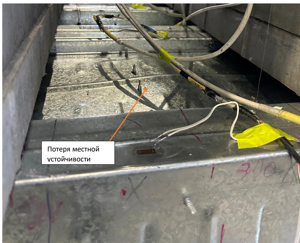
Рис. 9. Потеря местной устойчивости в пониженном участке верхней полки
