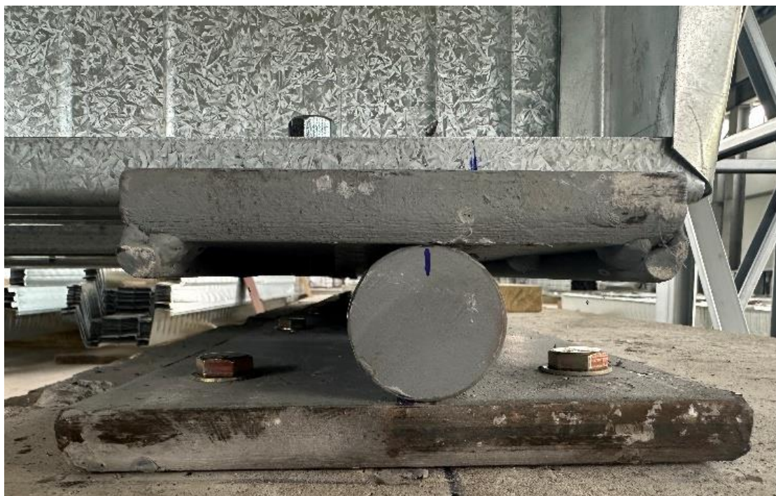
Рис. 5. Опираение профилированного листа на шарнирно-подвижную опору стенда
