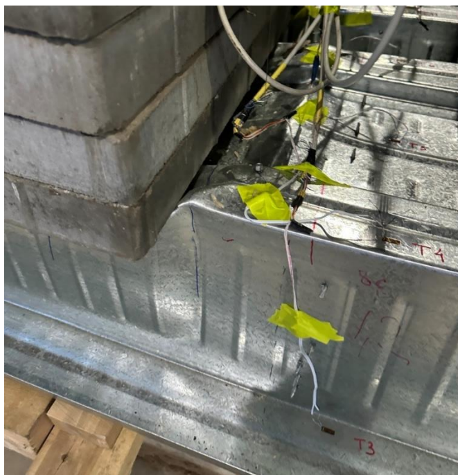
Рис. 10. Общий вид конструкции после потери несущей способности (до разгрузки)
