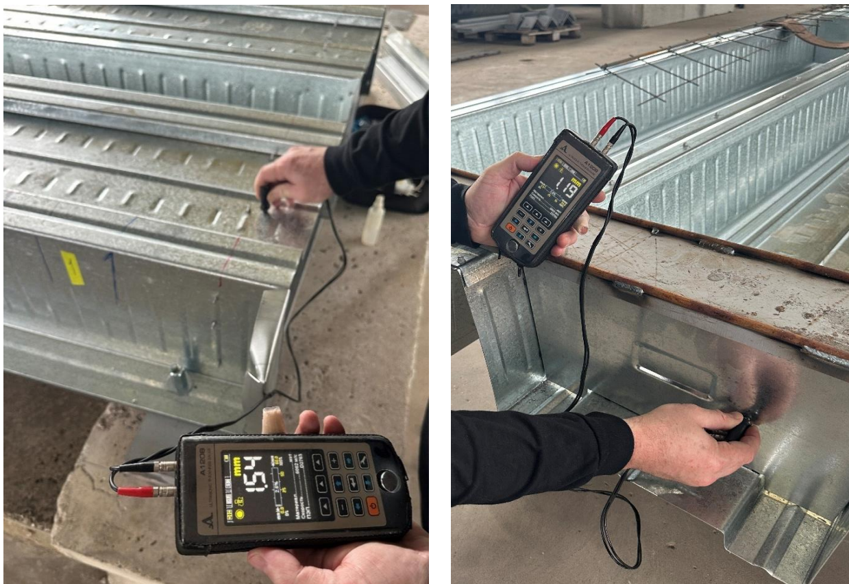
Рис. 4. Контрольные замеры толщин конструкции и элементов
