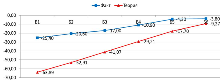
Рис. 13. Прогибы главных балок в сечении II при загрузении сечения III
