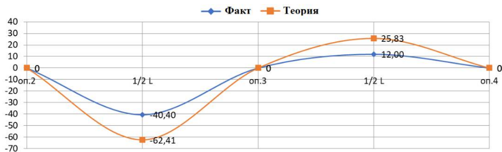
Рис. 9. График прогибов балки Б1 при загрузке сечения II
