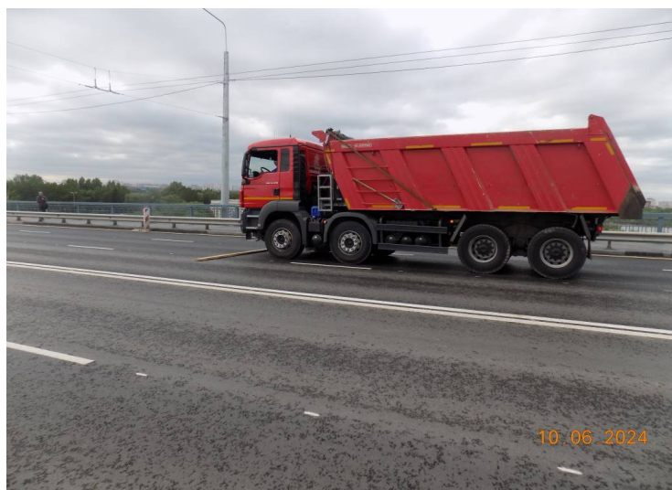
Рис. 19. Проезд испытательной нагрузки с порогом на проезжей части
