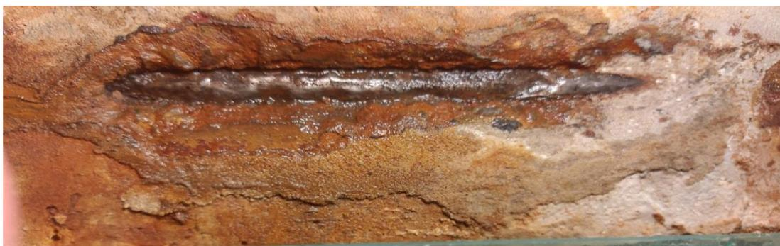
Рис. 10. Внешний вид арматуры после проведения гальванического ускорения коррозии арматуры
