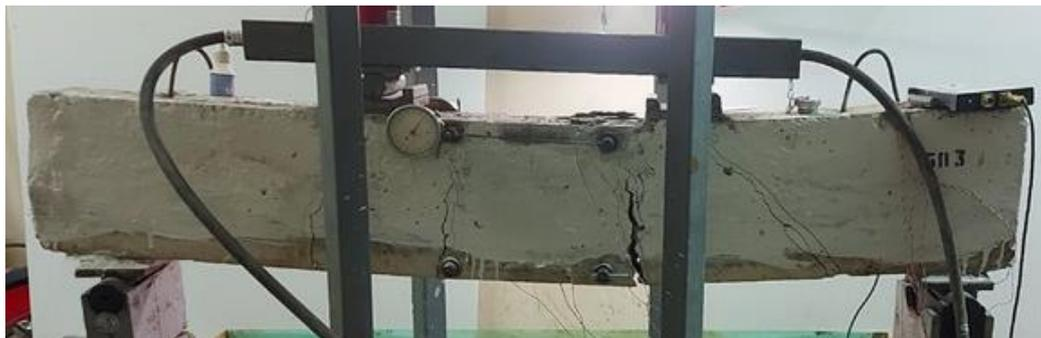
Рис. 11. Внешний вид изгибаемого элемента на стадии предразрушения
