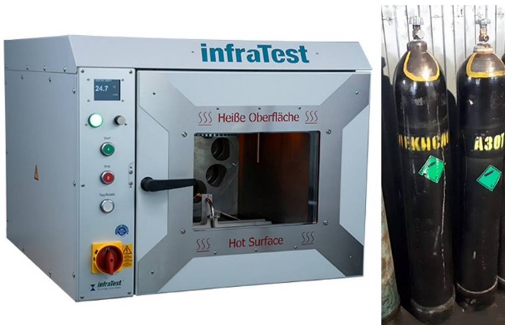
Рис. 2. Испытательная печь RTFOT InfraTest 20-25720 и баллоны с азотом и углекислотой
