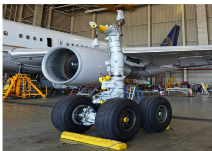
Рис. 15. Четырехколесная опора пассажирского самолета Boeing 767-300
