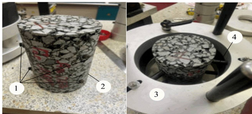
Рис. 1. Подготовленный для испытания образец асфальтобетона: 1 – металлические цилиндры, 2 – образец, 3 – специальное устройство для центрирования и монтажа металлических цилиндров, 4 – держатель металлических цилиндров
