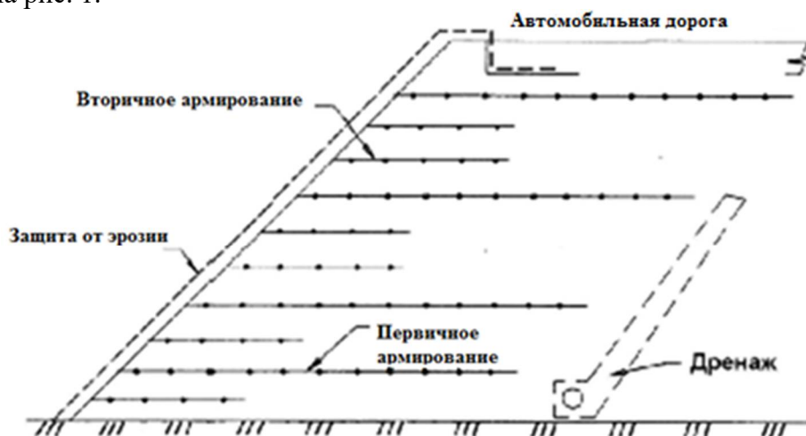
Рис. 1. Схема армирования и стабилизации откоса насыпи
