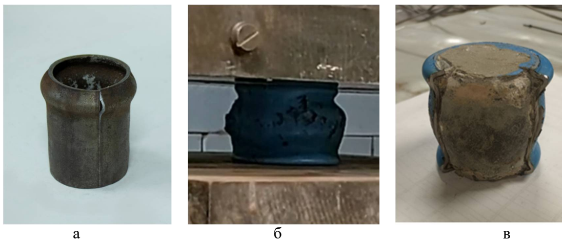
Рис. 7. Деформированный образец стальной трубы длиной 100 мм (а) и трубобетона (б), состояние бетонного сердечника после перехода в пластическую фазу (в)
