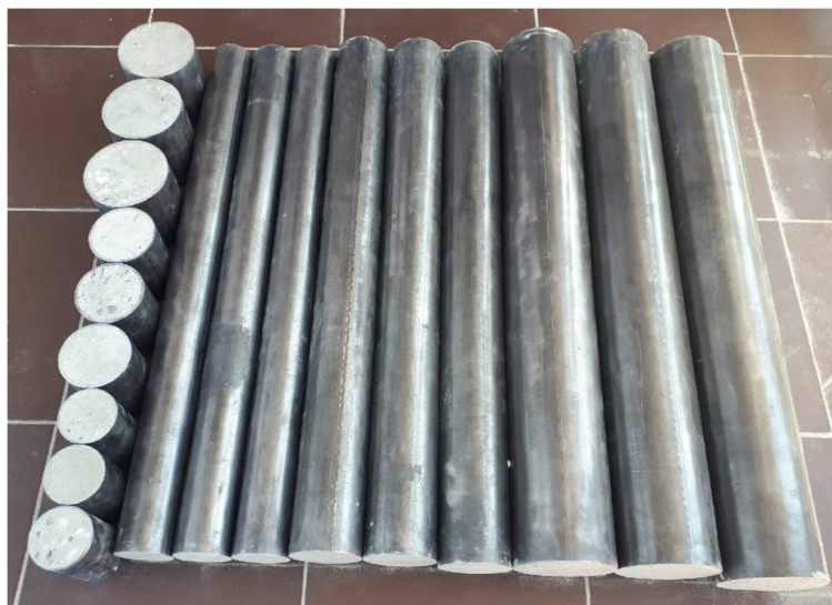
Рис. 1. Трубобетонные образцы для статических испытаний осевой сжимающей нагрузкой
