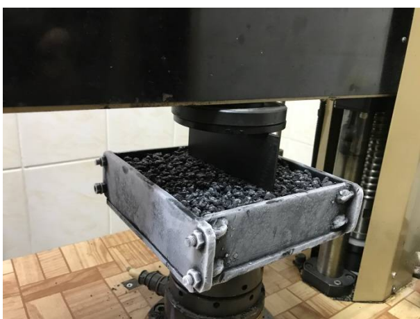
Рис. 3. Проведение испытания для определения показателя удобоукладываемости холодной смеси
