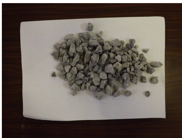
Рис. 3 Общий вид пробы шлакового щебня фракции 5-20
