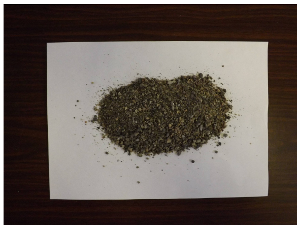
Рис. 2. Общий вид пробы шлаковой пемзы фракции 0-5
