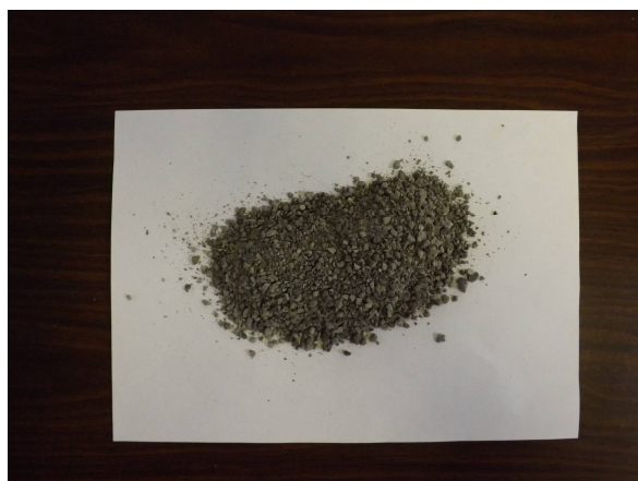
Рис. 4. Общий вид пробы шлакового песка фракции 0-5
