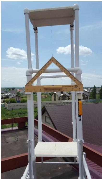
**Рис. 1.** Установка для экспериментального нахождения ветровой нагрузки
