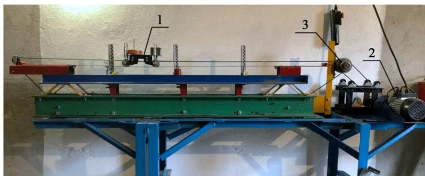
**Рис. 2.** Общий вид установки второго этапа исследований: 1 – подвижная тележка; 2 – электрический привод; 3 – ведомый шкив
