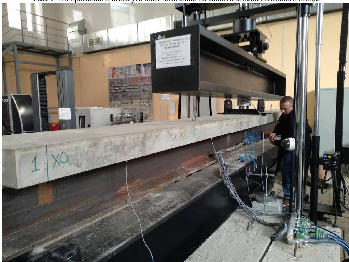
**Рис. 2.** Гидравлическая станция INSTRON 600 kN с установленной моделью
