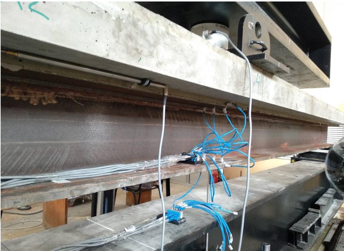
Рис. 4. Тензорезисторные датчики в середине балки
