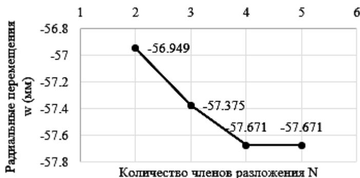
Рис. 15. График сходимости результата расчета радиального перемещения ( $w$ )
