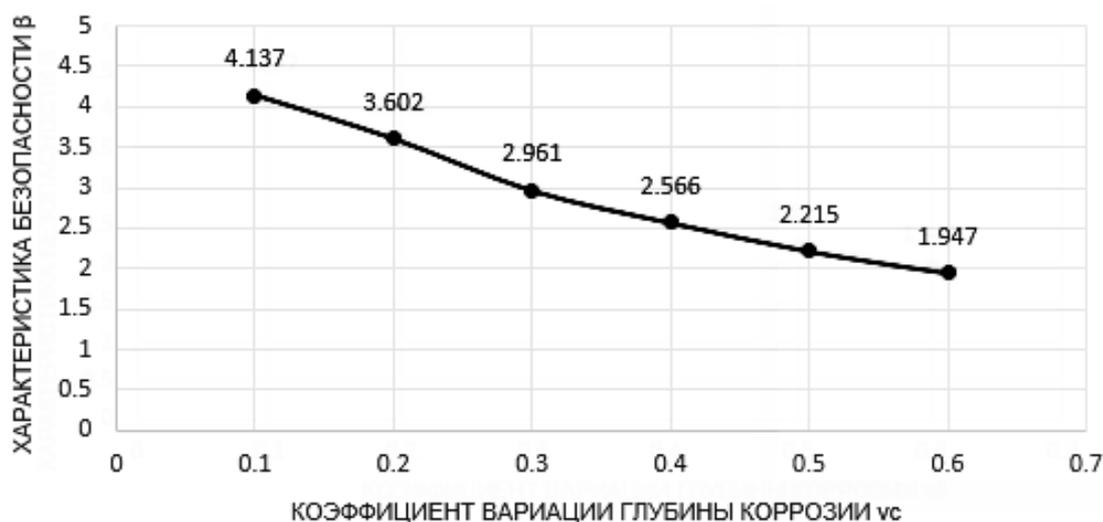
Рис. 4. Зависимость характеристики безопасности  $\beta$  от коэффициента вариации глубины коррозии  $v_c$
