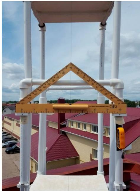
**Рис. 9.** Выполнение условия вертикальности установки
