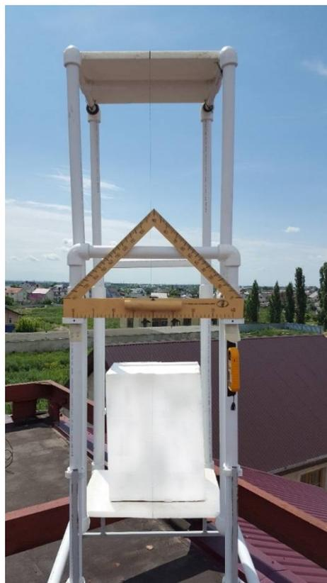
Рис. 12. Фиксирование угла отклонения площадки
