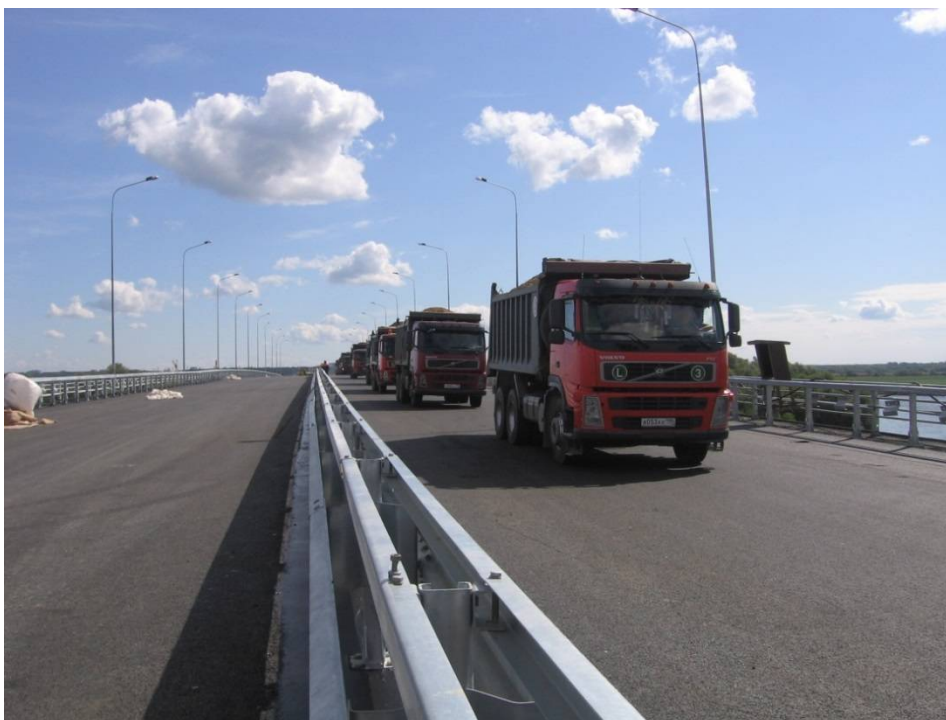
Рис. 4. Динамические испытания большепролетного моста через р. Москву в Московской области (2011)
