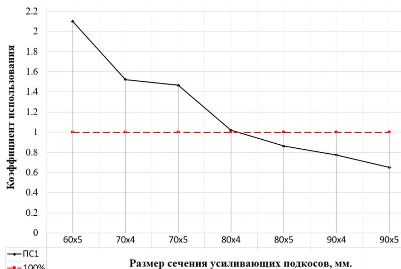
**Рис. 10.** Коэффициент использования усиливающего подкоса при различных вариантах жесткости
