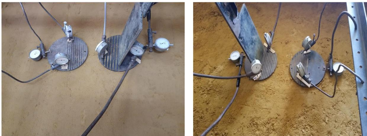
**Рис. 6.** Принятые обозначения и схема расположения индикаторов для нагруженного (а) и ненагруженного (б) штампов
