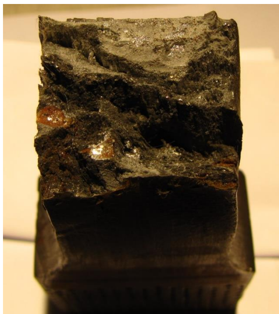
Рис. 3. Внешний вид поверхности разрушения после испытаний на статическое растяжение
