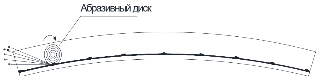
Рис. 3. Зачистка сварного шва
