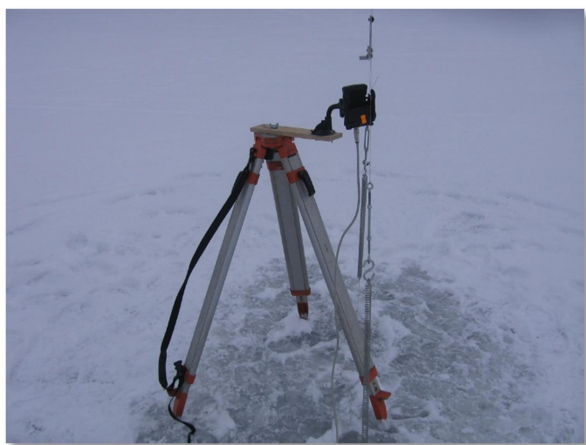
Рис. 3. Установка триангуляционного датчика, фиксирующего вертикальные перемещения трубопровода
