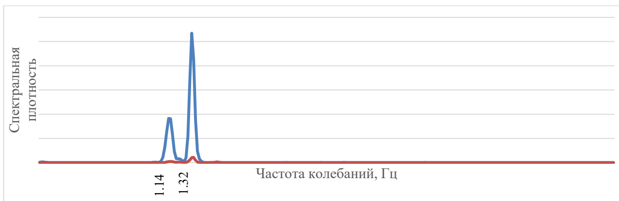
Рис. 8. Спектральный анализ графиков колебаний расчетных сечений от динамического воздействия по схеме «б»
