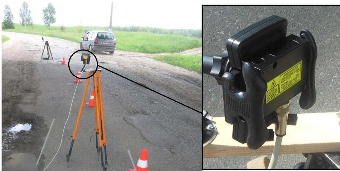
Рис. 2. Установка измерительных датчиков для регистрации прогибов в среднем сечении балок Б2 и Б7 пролета 2
