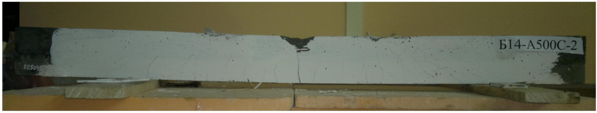
Рис. 3. Характерный вид разрушения балок
