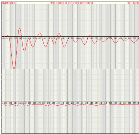
Рис. 7. Прогибы (а) и изгибающий момент (б) в середине пролетного строения
