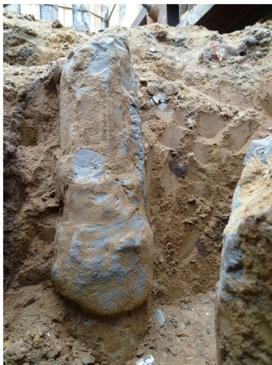
Рис. 4. Вид ствола уплотнения с уширением, обнаруженного в глинистом грунте в шурфе 1 на отм. 146,1м
